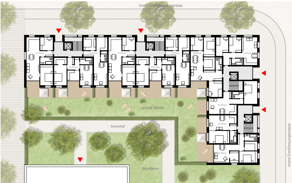
winkelförmiger Wohnungsbautyp Erdgeschoss 1:200
